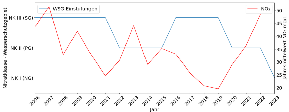
Abbildung 3 Beispiel für die Einstufung eines WSG, in dem die Einstufung aufgrund des Zeitversatzes zwischen Konzentrationsänderung und Einstufung keine angemessene Reaktion auf die Belastungssituation ermöglicht 1) .
